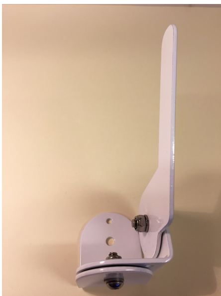
Figur 2. Feste for dreining med klokken.
