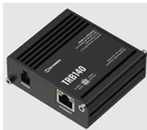
Figur 2: TRB140 (Teltonika 4G ruter) med antenne
